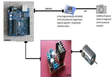
**FIG2: SYSTEM DESCRIPTION DIAGRAM**
