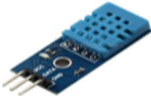
FIG 3 .SHOWS DHT 11A
