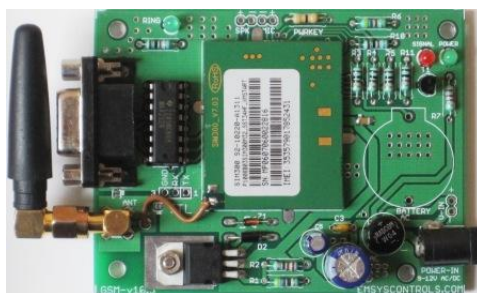
FIG 4: GSM MODEM USING SIM300 MODULE
