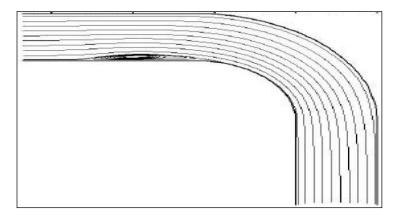
FIGURE 5. CURVED TUBE VORTEX DISTRIBUTION
