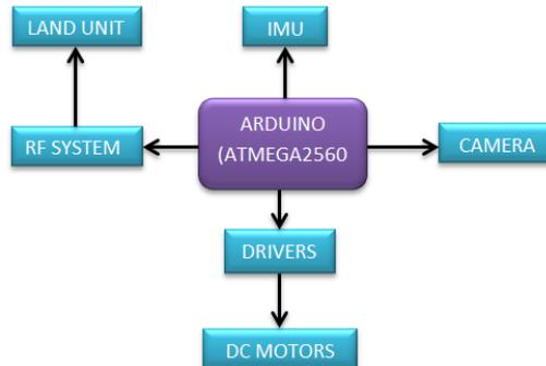
**FIGURE 5 SYSTEM ARCHITECTURE**
