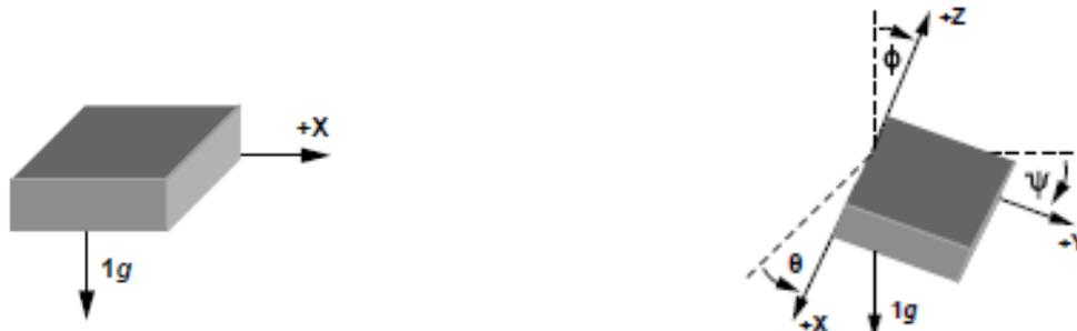
**FIGURE 6. FORCE OF GRAVITY EXPRESSED IN THE AXIS X, Y & Z [9].**
