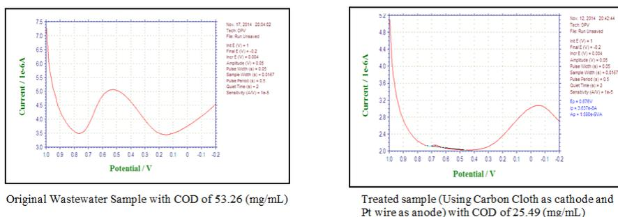
**FIGURE 2. DIFFERENT PULSE VOLUMERIC (DPV) RESULTS**
