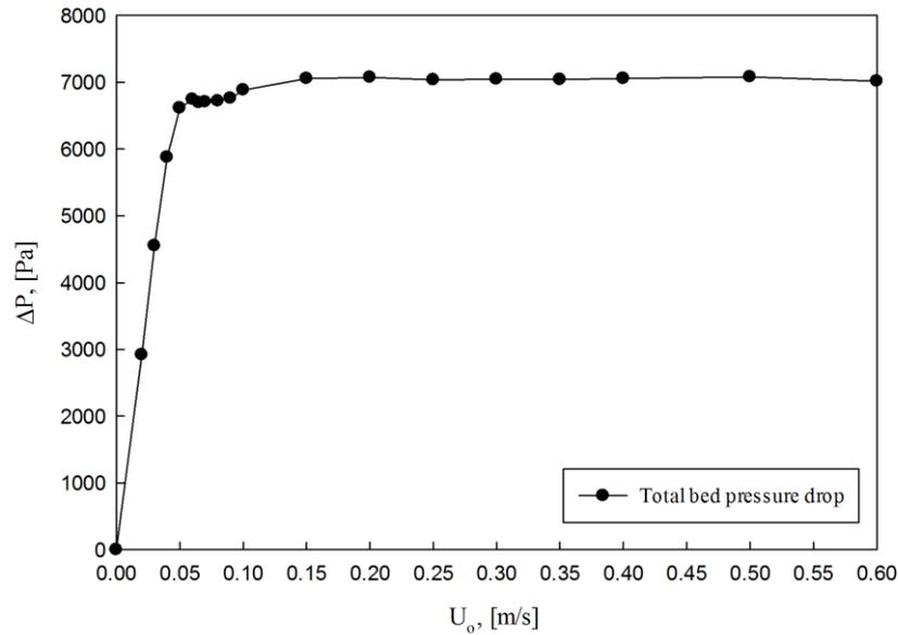
**FIG.5. TOTAL BED PRESSURE DROP OF ILMENITE-COKE MIXTURE ACCORDING TO SUPERFICIAL GAS VELOCITY**
