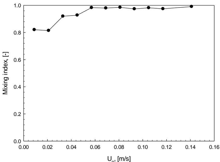
**FIG.11. MIXING INDEX OF CERAMIC BEADS-PLASTIC BEADS MIXTURE**
