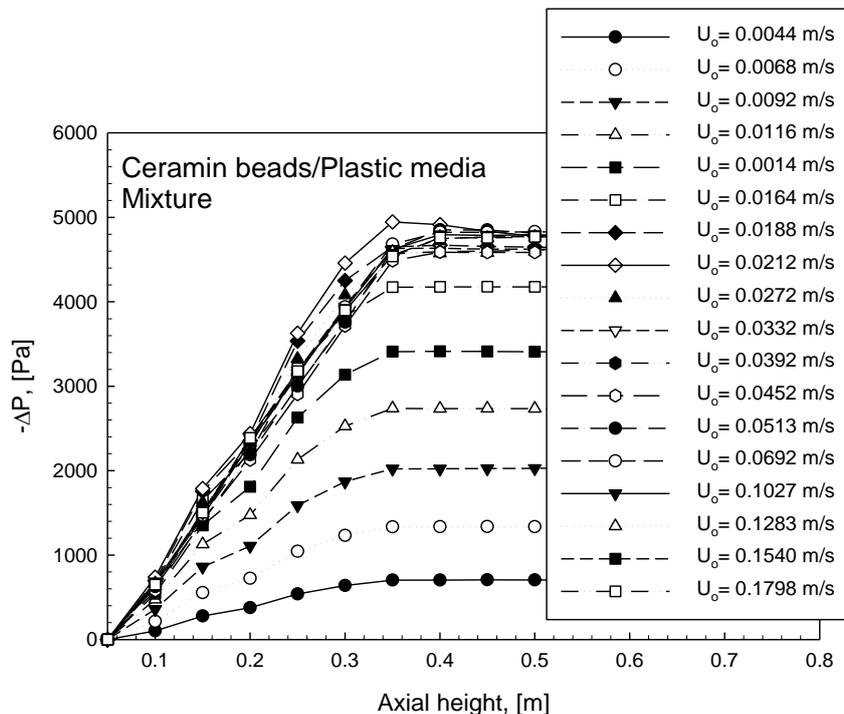
**FIG.8. AXIAL PRESSURE DROPS OF CERAMIC BEADS-PLASTIC BEADS MIXTURE**
