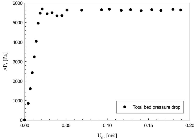
**FIG.9. TOTAL BED PRESSURE DROP OF CERAMIC BEADS-PLASTIC BEADS MIXTURE**
