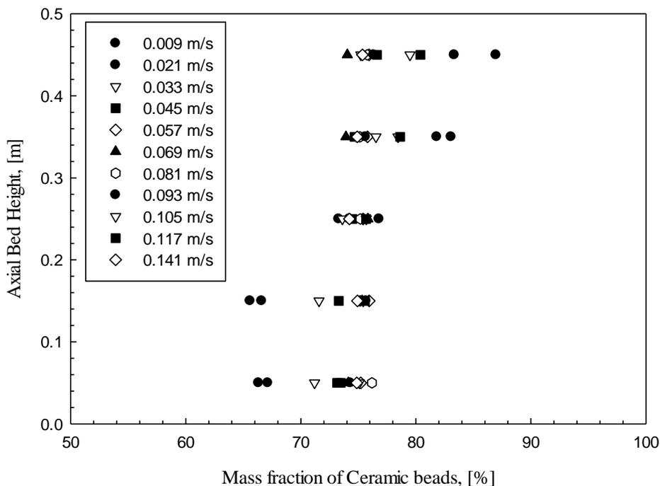
**FIG.10. AXIAL MASS FRACTION OF CERAMIC BEADS**
