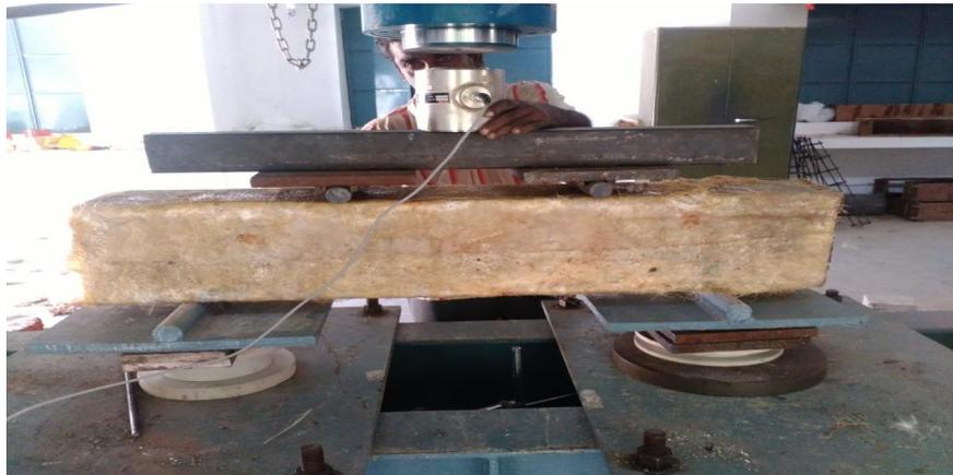
**FIG 18 TESTING OF FULLY WRAPPED BEAM**
