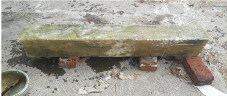
**FIG 14 GFRP U-WRAPPING ON THE BEAM**
