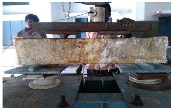
**FIG 16 TESTING OF BEAM AFTER STRENGTHENING**
