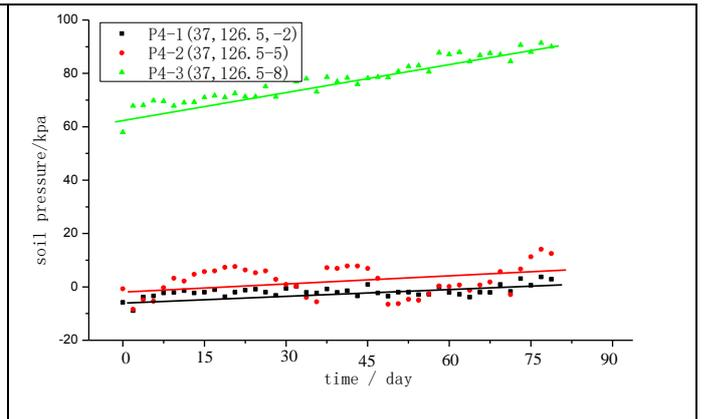
**FIG. 9 EARTH PRESSURE CHANGE CURVE ( EXTERNAL ANGLE X=37M)**
