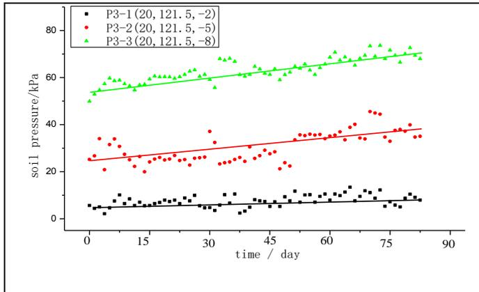
**FIG. 8 EARTH PRESSURE CHANGE CURVE ( x=20M)**
